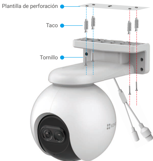
Figura 1. Montaje en techo
